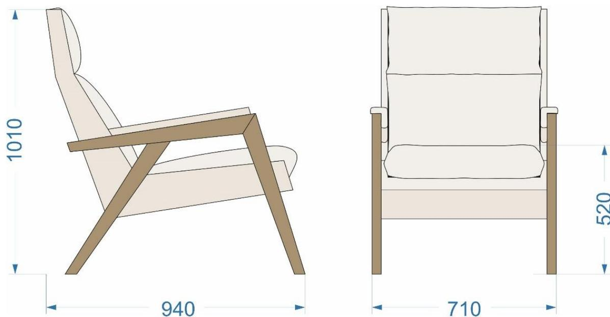
Габаритные размеры (Ш × Г × В): 710 × 940 × 1010 мм
