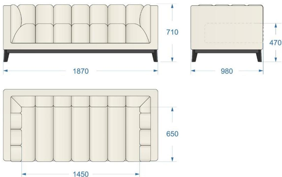
Габаритные размеры (Ш × Г × В): 1870 × 980 × 710 мм
