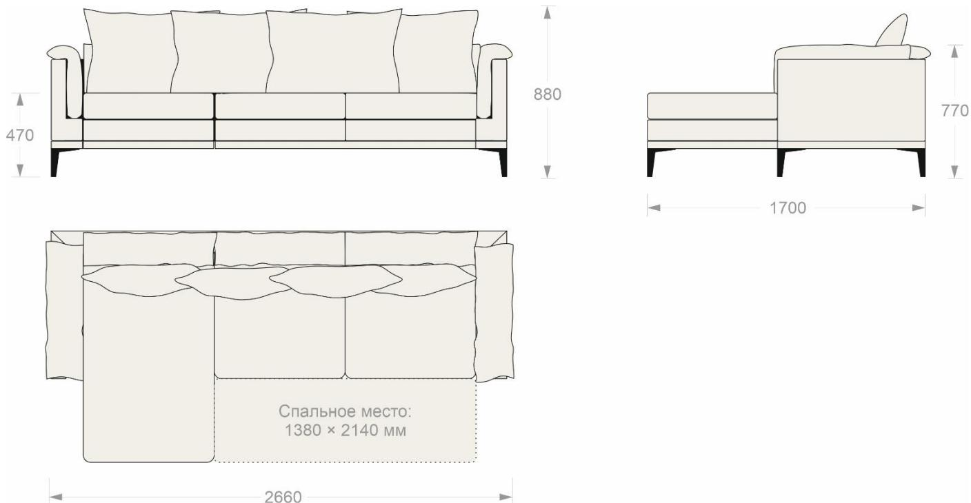
Габаритные размеры (Ш × Г × В): 2660 × 1700 × 770/880 мм
