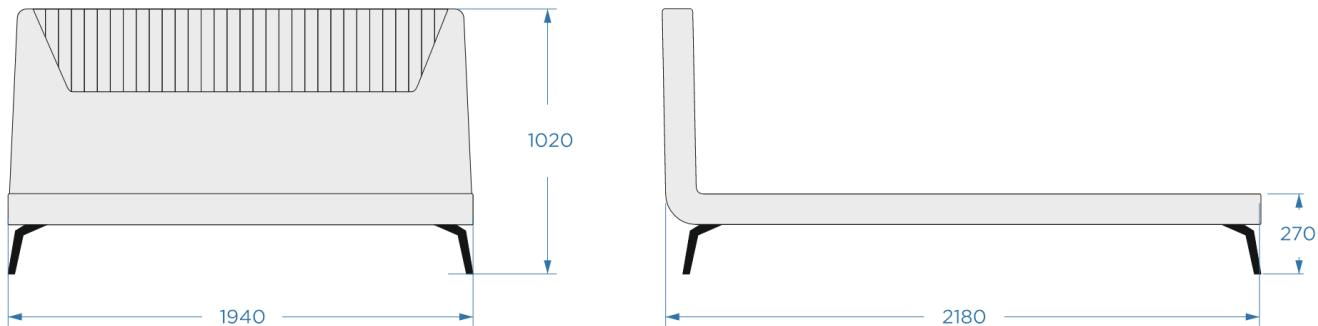
Габаритные размеры (Ш × Г × В): 1940 × 2180 × 1020 мм (для сп. места на 1800 × 2000 мм)
